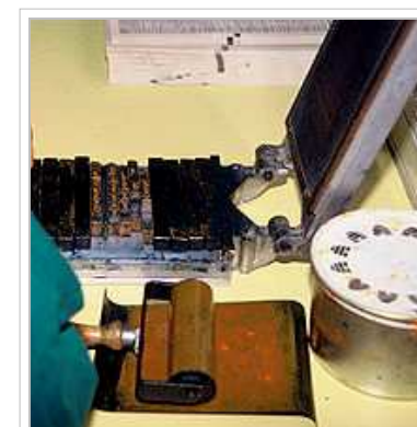
Eine Klappflügelpresse in der École Freinet, Vence
